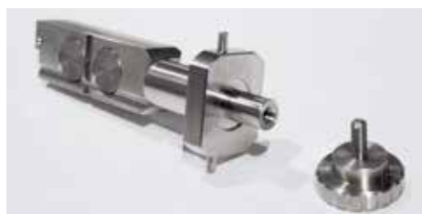
Пример использования крепления для быстрой замены держателя
