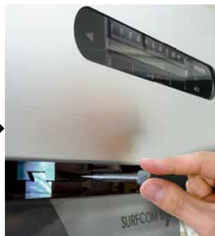
Для блокировки или разблокировки детектора достаточно повернуть штифт на полоборота по часовой стрелке или против часовой стрелки соответственно
