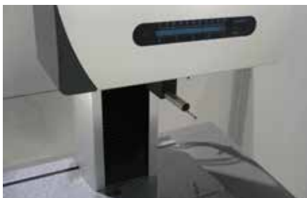
Изменение направления держателя позволяет выполнять горизонтальные измерения
