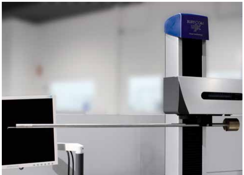
Дополнительный соединяющий вал для сверхдлинных отверстий
