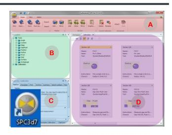
GapGun необходимо Перед использованием предварительно сконфигурировать на последовательное прохождение мест сканирования (Элементов), каждый из которых имеет изображение, тип измерения (например, зазоры и смещения) и индивидуальные пределы отклонений.
