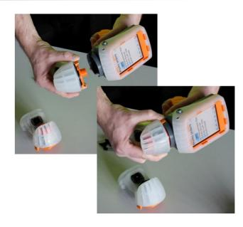
Чтобы заменить головку датчика необходимо нажать на оранжевые фиксаторы Vchange и снять датчик с рукоятки. Затем установить новый датчик на место до щелчка фиксатора. Датчик может быть заменен без выключения GapGun.
