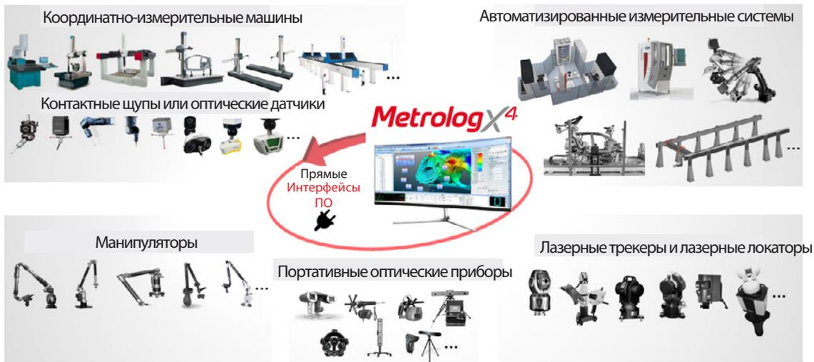
**Технология прямых интерфейсов Metrolog X4** позволяет вам с лёгкостью подключать более 100 различных устройств, используя имеющиеся контроллеры оборудования и нативные протоколы.
